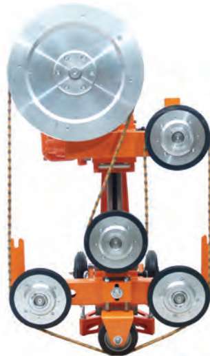
Kernbohrständer KB400 als Trägergerät
